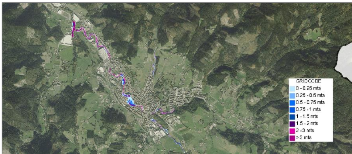
Imagen 72: Calado para periodo de retorno de 100 años Fuente URA y Geoeuskadi. Elaboración propia
